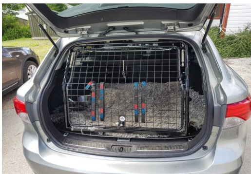
Toyota Avensis Touring 2008- Grind Modell 2 dubbeldörr Lutninghåll nr 3. Då övre utfyllnadsenhet inte behövs kan en grind modell 1 lika gärna användas till denna bil. Utfyllnadsrör med knapp utgick 201809 och har ersatts av "Hundben"
