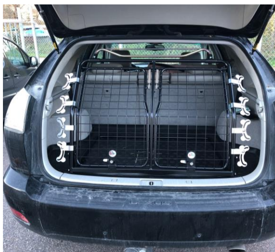
Grind modell 2 dubbeldörr i en Lexus RX gen II Hundbenen kan vridas så de sitter tvärtom eller når mer rakt ut då fästet kan sitta på valfritt ställe i skåran som löper i mitten av hundbenet. Allt för att få till den bästa passformen på just er bil.
