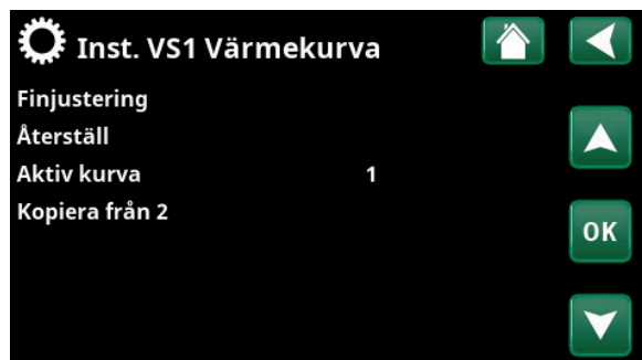
Meny "Avancerat/Inställningar/Värmesystem/Värmesystem 1/Värmekurva".
