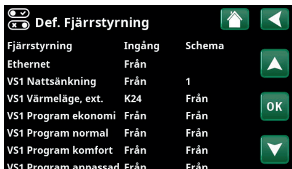
Del av meny "Avancerat/Definiera/Fjärrstyrning".
