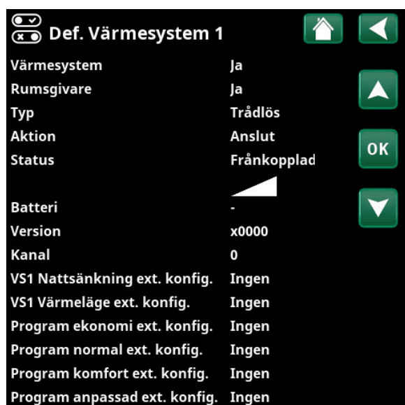
Meny "Avancerat/Definiera/Värmesystem/Värmesystem 1". Trådlös rumsgivare har valts.
