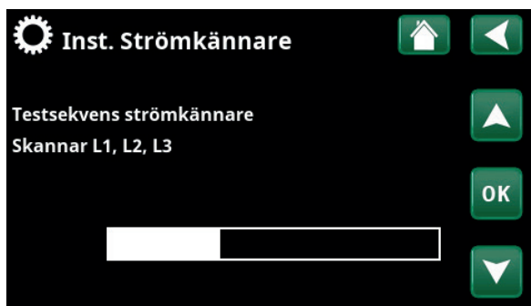
Meny "Avancerat/Inställningar/Strömkännare/Automatkonfig. strömkännare".
