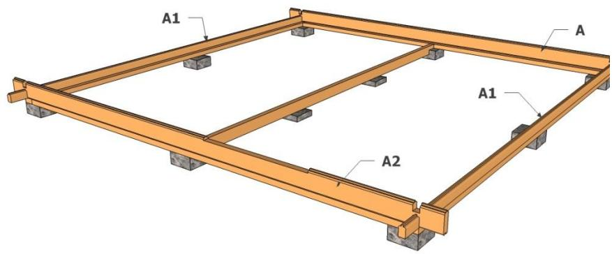
Slå ihop varv efter varv enligt bilden. Använd slägga och medföljande slagklossar. Slå aldrig direkt på en bräda.
