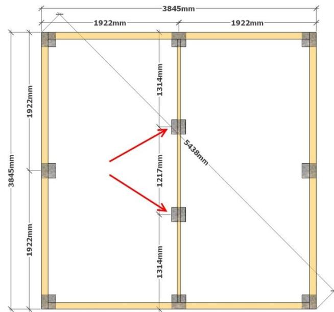
Lägg ut syllbrädorna på grundstenarna. Kapa ur 50mm i bärlinan enligt bilden. Längden på urtaget beror på storleken på grundstenen. Kontrollmät diagonalen på syllen för att vara säker på att den är i vinkel.
