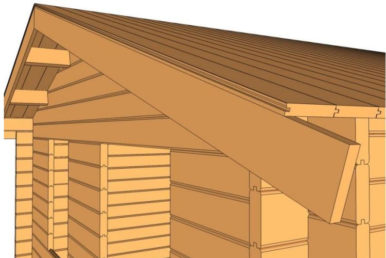
Skruba fast de övre vindbrädorna. Förskjut vindbräden ca 5cm uppåt.
