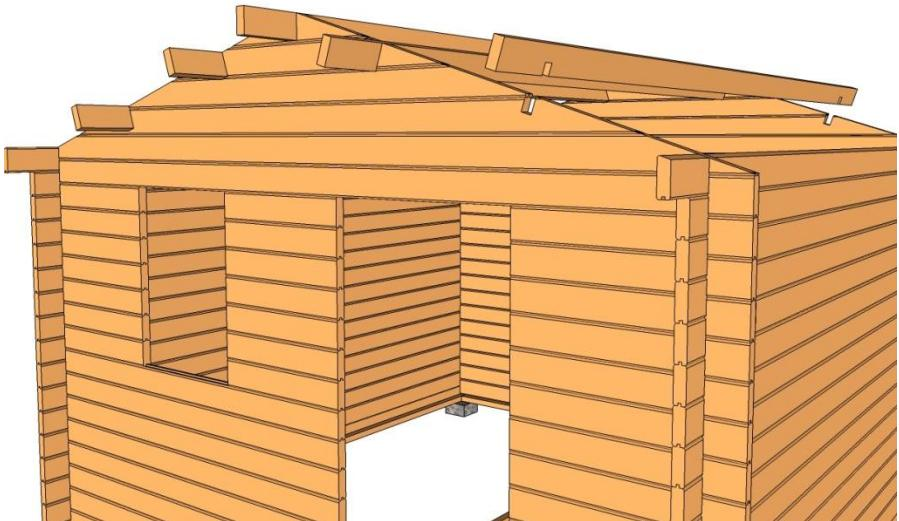
Ett tips när man spikar taket är att ta en takfotsbräda och fästa den med ena längssidan mot centrum pånocken. Då kan man styra takbrädorna mot denna när man spikar taket. Stick ut brädorna drygt 30cm utanför sidoväggen. Tillkapning av takbrädorna sker efter montering.
