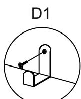
Montera hakbeslagen enligt bild med hjälp av insexnyckeln.
