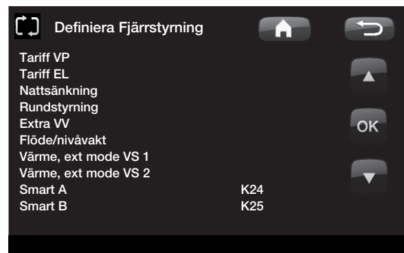
Exempel där Smart A blivit tilldelat lågspänningsingång K24 och Smart B blivit tilldelad lågspänningsingång K25
