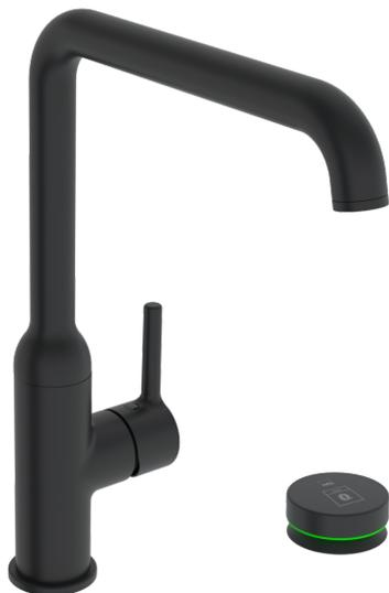
Köksblandare med elektronisk avstängningsventil, 230/9VDC via plug-in transformator. Bluetooth, Automatisk avstängning 4/12 timmar. Ettgreppsfunktion via pinnspak, hög svängbar J-utloppspip och strålsamlare. Utloppspipens svängradie är förinställd på 120° (kan begränsas till 0°/60°/360°). Inbyggd spärr för begränsning av temperatur och flöde via Oras 3.0 keramiska kassett. F = flexibel anslutning.
