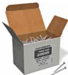
Rostfri spik För fastsättning av takpannor. Kamspik 3,1 x 75 mm.
