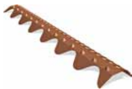
Ventinock Tätar och ventilerar nock, 0,9 m täckande längd. 2,2 stk / löpmeter nock.
